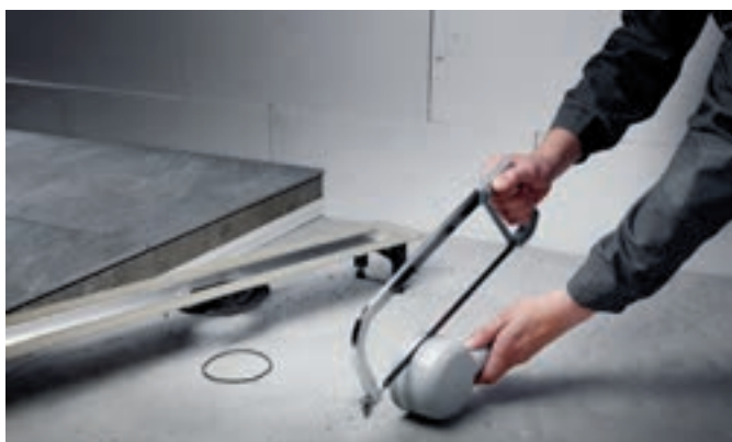
Стандартният сифон може да бъде скъсен по височина и да достигне височина от само 70 мм, колкото е и височината на плоският модел.
