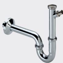
Sifon din țevi sifon Plus - alamă cromată echipare Racord filetat pentru furtun G¾, capac de închidere, țeavă prelungitoare 200 mm, cot de scurgere 220 mm controlat în privința calității conform normei DIN EN 274 model 5611.6
